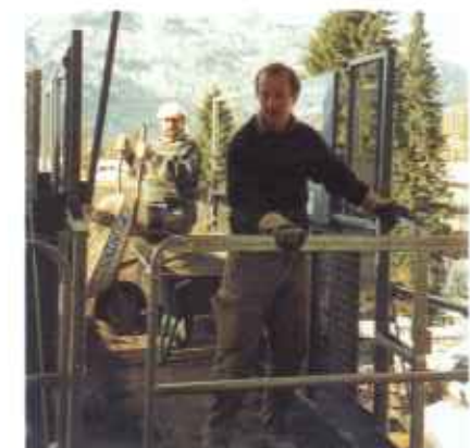
Zur Absturz-sicherung werden an den Be- und Entladestellen feuerverzinkte Etageeinrichtungen (1 Stück im Lieferumfang enthalten) mit mechanisch verriegelter Schiebetür montiert.
